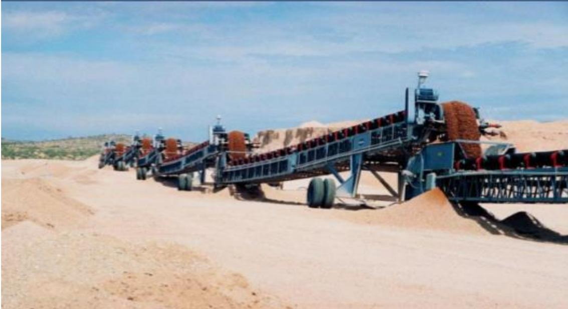
**FIGURA 12:** *Sistema de Faja con Plataforma Sobre Llanta*
