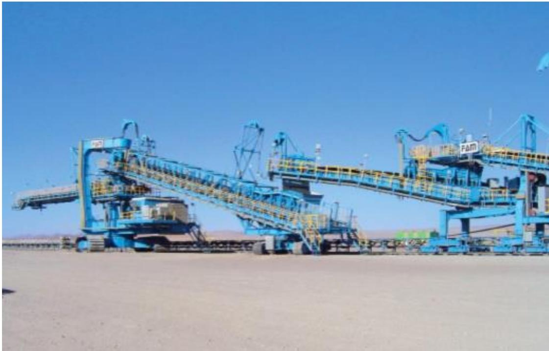
**FIGURA 11:** *Sistema de Faja con Plataforma sobre Oruga.*
