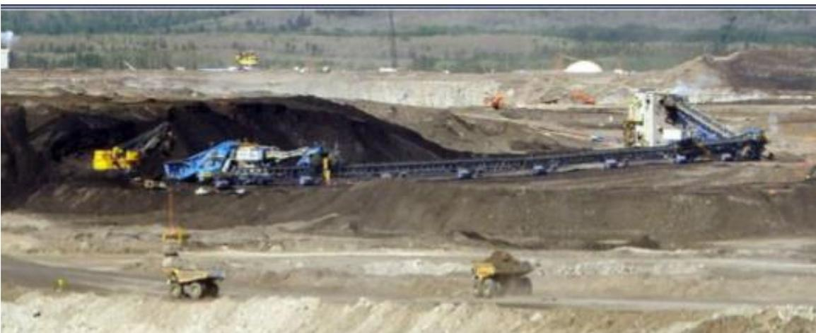
**FIGURA 10:** *Sistema de Transporte por Faja Móvil.*
