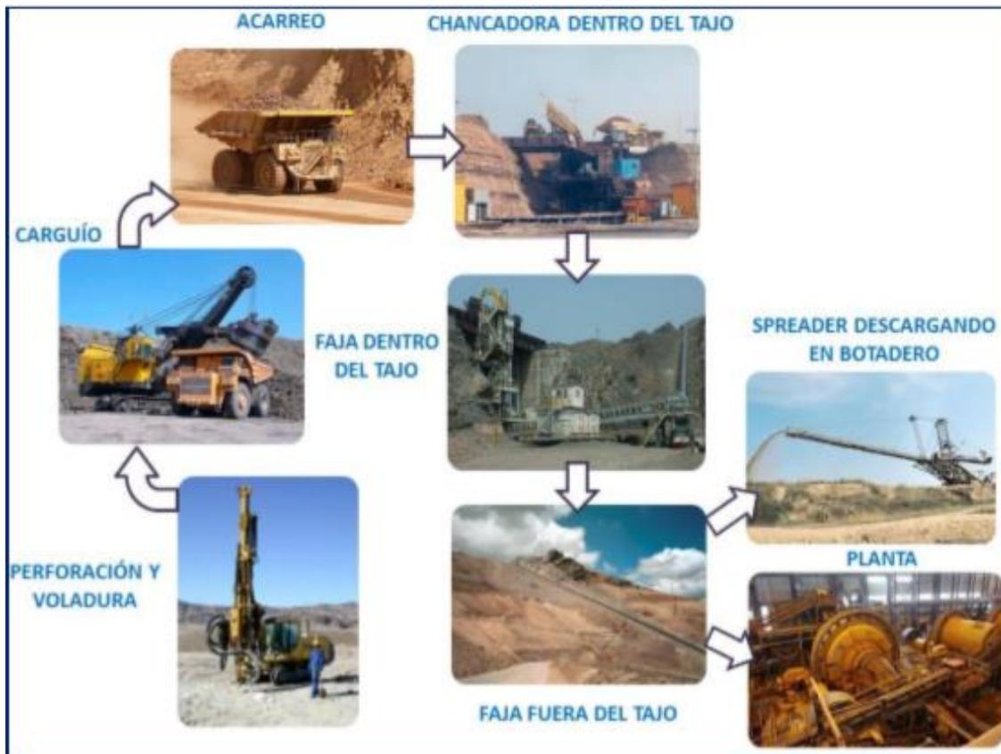
**FIGURA 4:** Ciclo de Explotación con el Sistema IPCC.
