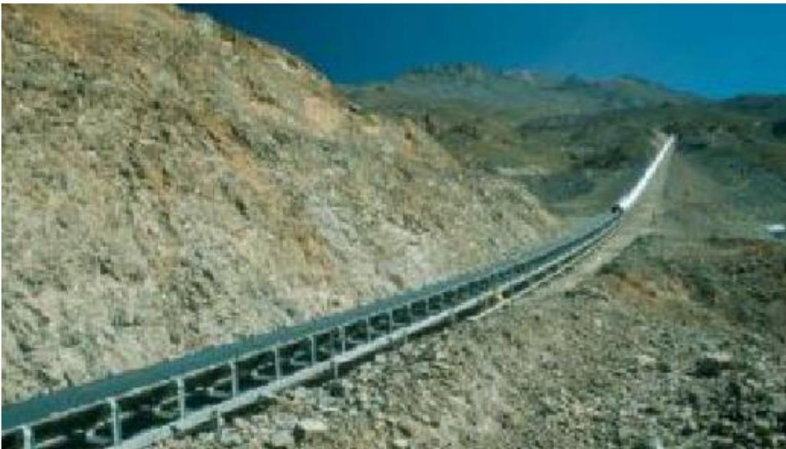
**FIGURA 8:** Sistema de Transporte por Faja Fija.
