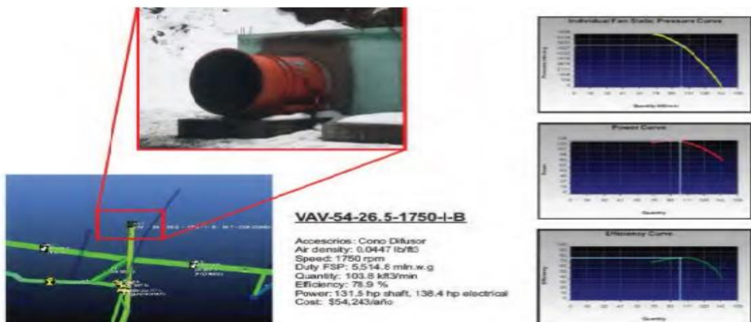
FIGURA 16: Parámetros de operación de ventilador principal Nv 5 ½ Animas
